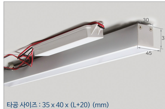
라인70x60(50 날개형) 안정기 내장형 규격 : W 70 x H 60 x L(mm) 날개 각 10mm
